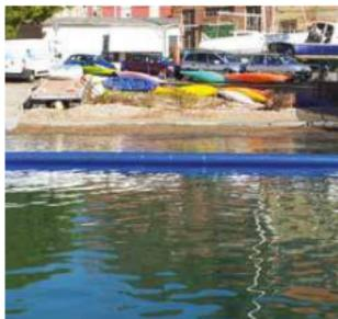
La barriera antinquinamento gonfiabile, costruita con PVC a tenuta d'aria utilizzato per la produzione dei gommoni, viene usata quando lo spazio di stoccaggio è limitato ed è necessaria grande riserva di spinta. Viene fornita in moduli standard da 10 o 25 mt. Ciascun modulo viene collocato, per la movimentazione e il trasporto, su pallet.
