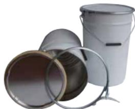
Secchio conico in acciaio banda stangata con coperchio metallico, chiusura ad anello e leva a scatto, saldatura longitudinale del mantello con una nervatura di rinforzo anti-incastro e maniglia ad arco, verniciatura smalto a forno bianco RAL9010, con interno grezzo.
