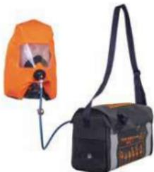
L'SK1203 è un autorespiratore ad aria compressa a circuito aperto con cappuccio per la fuga. Destinato all'uso per auto salvataggio in tutti gli ambienti in cui si possono verificare situazioni pericolose dovute alla presenza di fumi di incendio o mancanza di ossigeno. Progettato per garantire all'utilizzatore un flusso di aria costante per 15 minuti.
